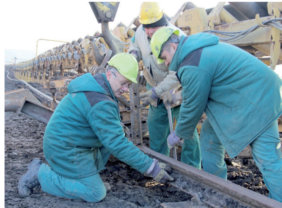
Kontrolovat spoje u jednotlivých dílů pásových dopravníků se musí za každého počasí. Foto: (pim)
