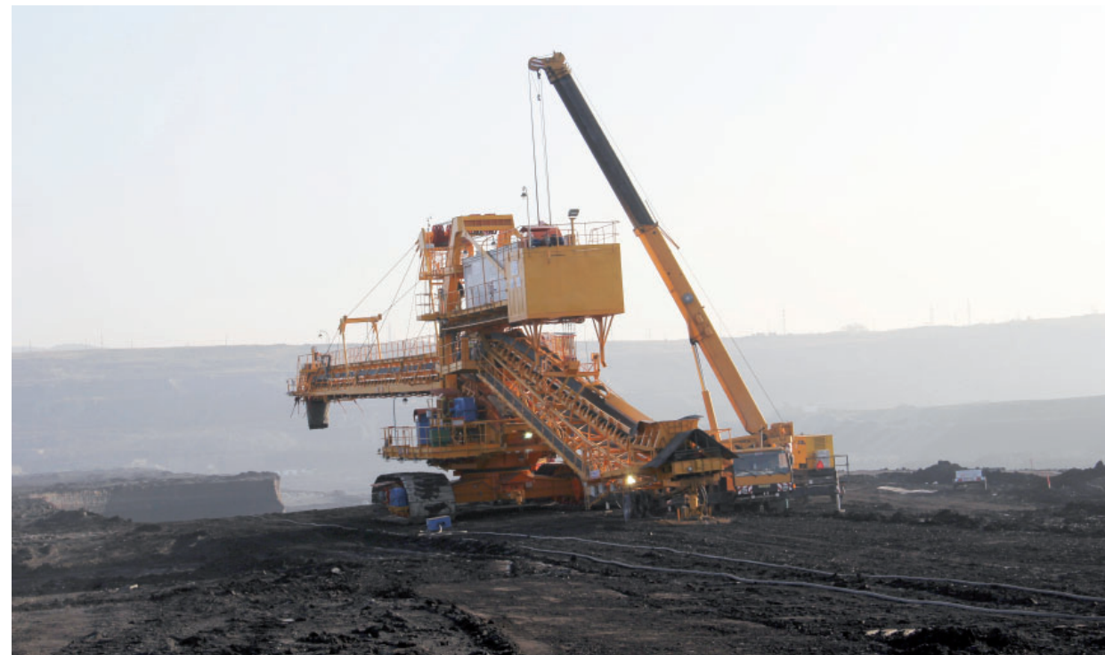
Pásový vůz zakládací v době těsně před skončením generální opravy. Foto: (pim)
