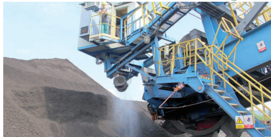
Atomizéry jsou nainstalované i přímo pod kabinou skládkových strojů. Foto: (pim)
