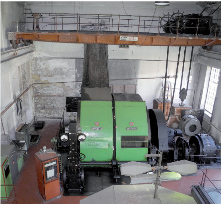
Elektrický těžní stroj Škoda z roku 1932 v expozici Hornického skanzenu Mayrau ve Vinařicích. Foto: Jiří Chmelenský
