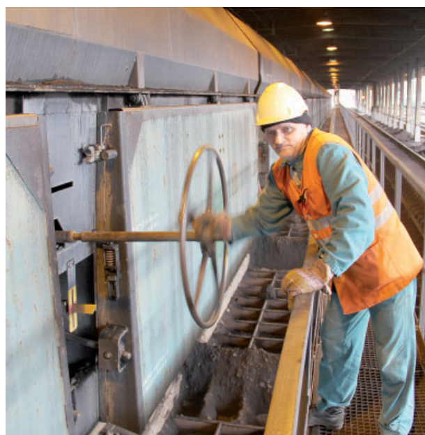
Uhlí se dopraví na úpravnu v železniční soupravě. Každý vagon se musí ručně otevřít a vyklopit do hlubinných zásobníků.
