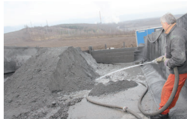
Báňští záchranáři v současnosti plaví popílek například v prostoru Hořan. Foto: (pim)
