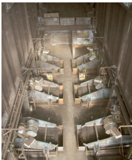
Symbolické srdce úpravný. Třídírna, kde se uhlí upravuje na požadovanou zrnitost.
