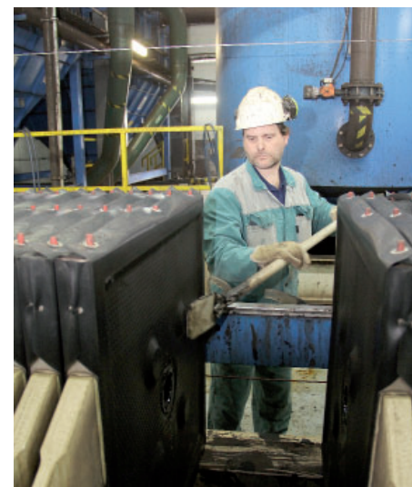
Veškerá voda z úpravný uhlí prochází takzvanými kalolisy. Vycištěná voda se vrací zpět do provozu a kaly se dále zpracovávají. Foto: 6x (pim)
