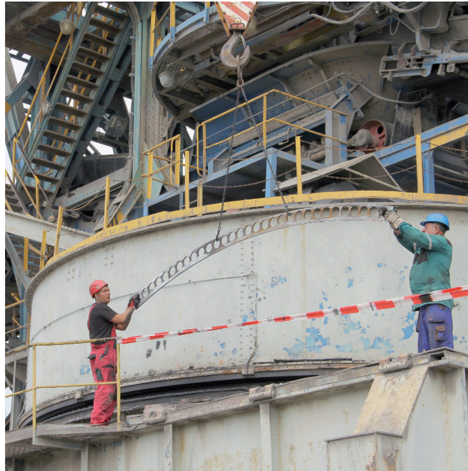
S kontrolou kulové dráhy zakladače pomáhali kromě osádky stroje i báňští záchranáři. Foto: (pim)
