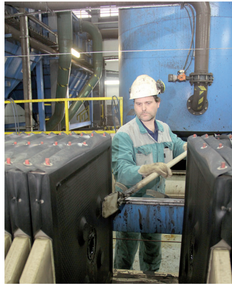
Filtrační koláč by se měl z kalolisu uvolnit sám, pokud se tak nestane, musí to udělat obsluha kalolisu ručně. Foto: Archiv DN
