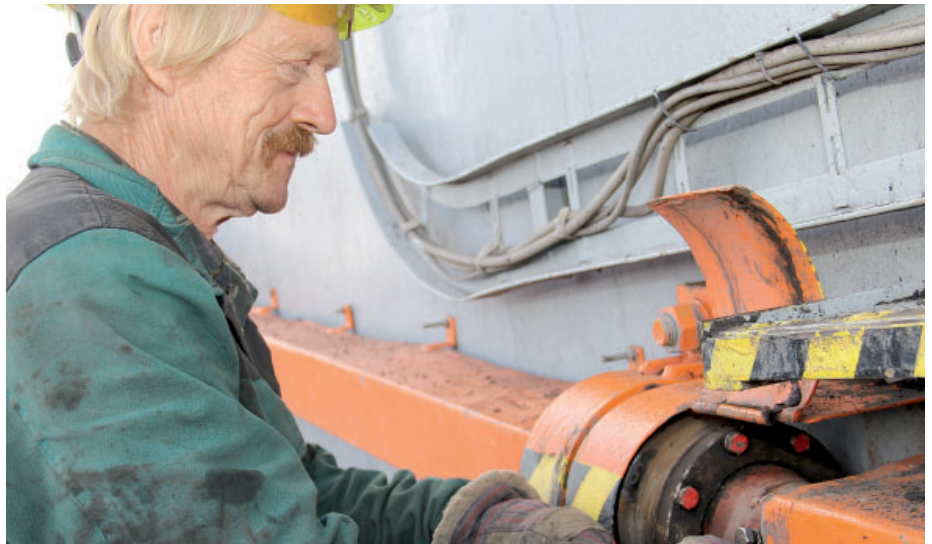
Klapkař Josef Volný prohlédl části zařízení, které slouží k otáčení horní stavby velkostroje. Foto: (pim)
