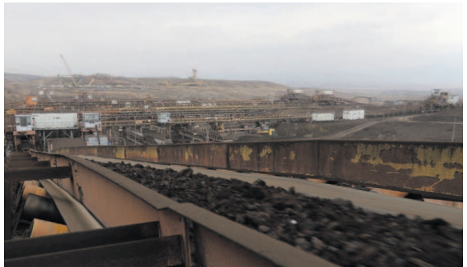
Vytěžené uhlí putuje k nakládce po pásovéch dopravnících. V lomu Vršany jeho cesta vede přes takzvané výsuvové hlavy. Nacházejí se na určitém dopravním uzlu, kde se sbíhají linky pásovéch dopravníků a jejich úkolem je směřovat materiál na správné místo určení. Jejich pomocí lze také plynule regulovat tok materiálu na dopravnících, stejně tak například „míchat“ kvalitu uhlí, které putuje k nakládce od uhelných velkostrůjů. Foto: (pim)
