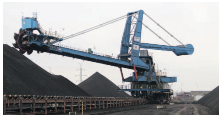
Ne všechno uhlí musí okamžitě po vytěžení zamířit k nakládce do železničních souprav. Někdy nejprve zamíří ke skládkovému stroji, kde se ukládá podle kvality a následně se pak dá namíchat správná směs podle požadavků zákazníka. Foto: (pim)
