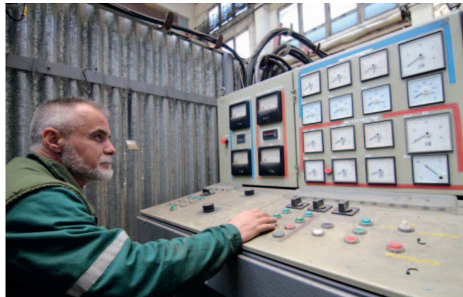
U každého motoru se před opravou dělá takzvaný náhled ve zkušebně. Foto: (pim)
