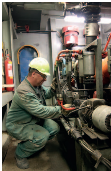
Hlídat se musí i veškerý chod v útrobách rypadla, tedy například hydraulika, kterou kontroluje zástupce řidiče velkostroje Petr Blum.
