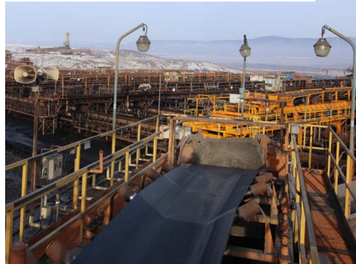
Pokud uhlí nezamíří k nakládkce pro zákazníky, může skončit na skládce k pozdějšímu využití. Skládkový stroj USSK umí uhlí jak sypat, tak v případě potřeby odtěžit a po dopravníkových linkách poslat k nakládkce.
