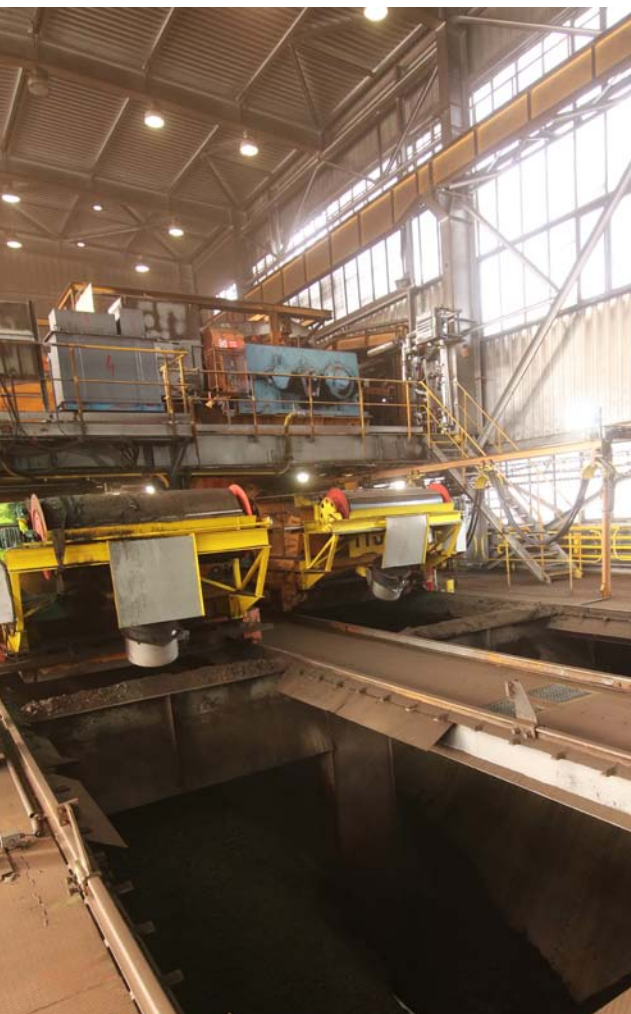
Další zastávkou paliva pro počeradskou elektrárnu jsou nakládací zásobníky, odkud se uhlí nakládá do železničních souprav.
