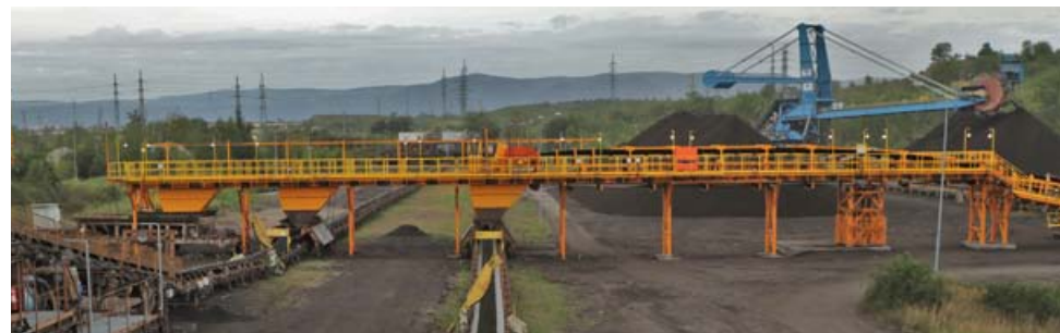
Nová výsuvová hlava pomáhá plynule distribuovat uhlí na některou ze tří dopravníkových linek. Foto: (pim)
